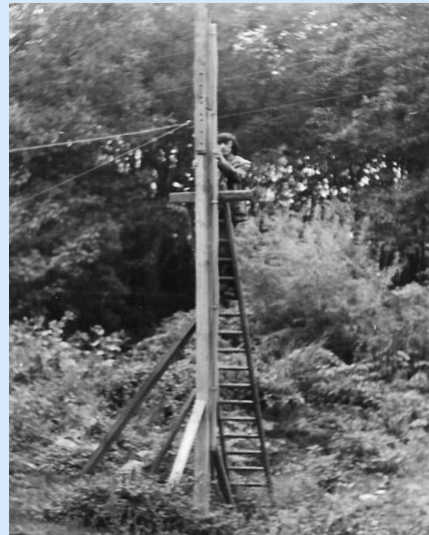
Artesische Grundwassermessstelle mit Hilfsgerüst beim Pumpversuchsmonitoring
