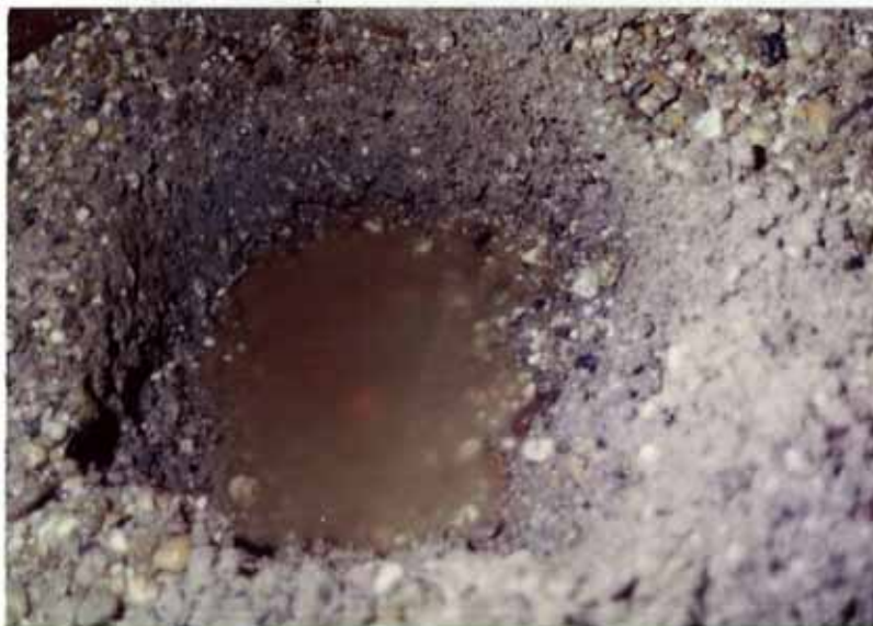
Bild 12: Innere Kolmation in der Elbsohle
