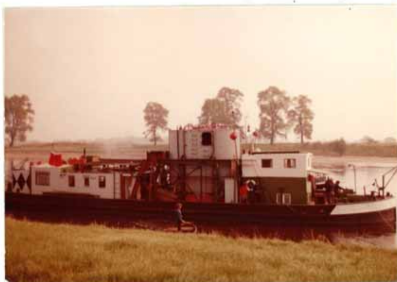
Bild 8: Spezialboot mit Taucherschacht in Schiffsmitte
