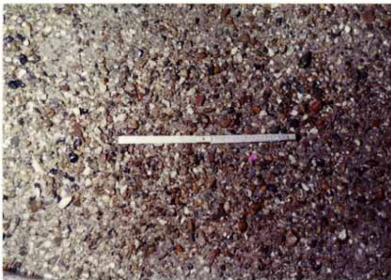
Bild 10: Deckschicht der Elbsohle im Mittellauf
