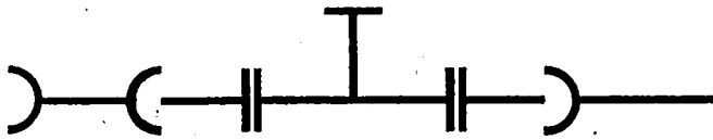
Einbindungsmöglichkeiten von Formstücken – Abzweigen – in PVC-hart-Druckrohrleitungen NW 150
