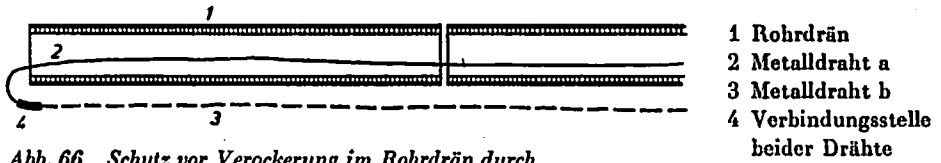
Abb. 66 Schutz vor Verockerung im Rohrdrän durch 2 verschiedene Metalldrähte
