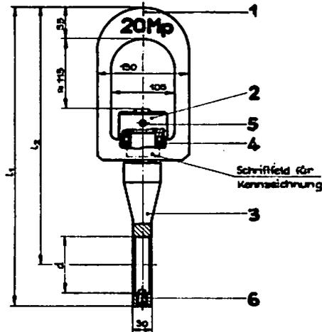
Bezeichnung eines Tragbügels von 20 Mp Tragfähigkeit und Tragaugendurchmesser  $d = 85$  mm:
