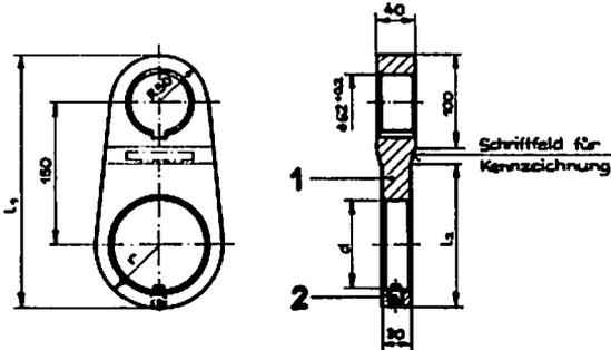
Bezeichnung einer Augenlasche von 20 Mp Tragfähigkeit und Tragaugendurchmesser  $d = 85$  mm:
